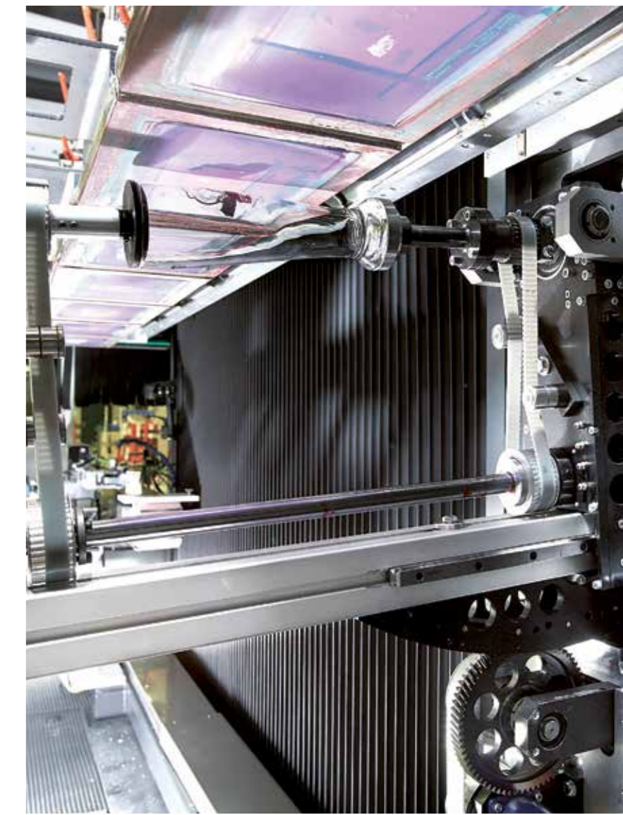
Kippbare Aufnahmevorrichtung für konische Artikel Tilttable article carrier for conical articles Support d'article pivotant dans les deux sens pour articles coniques
